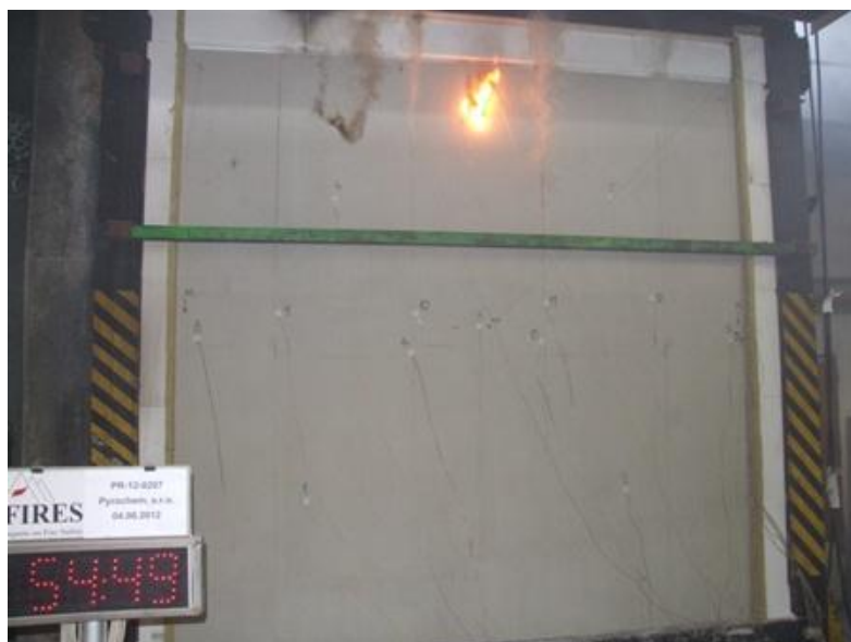
55. minúta skúšky Trvalé horenie – celistvosť vzorky bola porušená. Ukončenie skúšky
