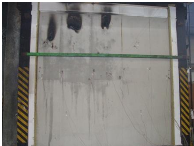
Neohrievaná strana vzorky po ukončení skúšky
